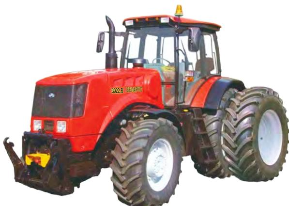
Тракторы 3022 предназначены для выполнения энергоёмких сельскохозяйственных работ в тяговом и тягово-приводном режимах в составе широкозахватных и комбинированных агрегатов, в том числе при эшелонированной навеске, на основной и предпосевной обработке почвы, посеве зерновых и других культур, заготовке кормов, уборке корнеплодов, зерновых и технических культур; для выполнения транспортных работ, стационарных работ, в строительстве и промышленности.
