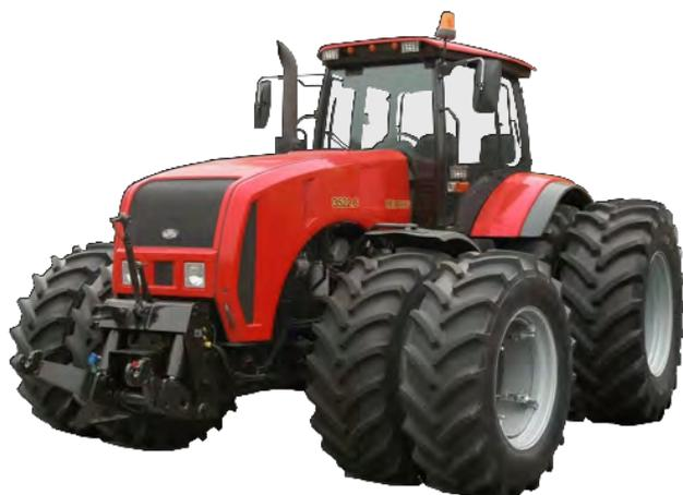
Тракторы 3522 предназначены для выполнения энергоемких сельскохозяйственных работ в тяговом и тягово-приводном режимах в составе широкозахватных и комбинированных агрегатов, в том числе при эшелонированной навеске, на основной и предпосевной обработке почвы, посеве зерновых и других культур, заготовке кормов, уборке корнеплодов, зерновых и технических культур; для выполнения транспортных работ, стационарных работ, в строительстве и промышленности.
